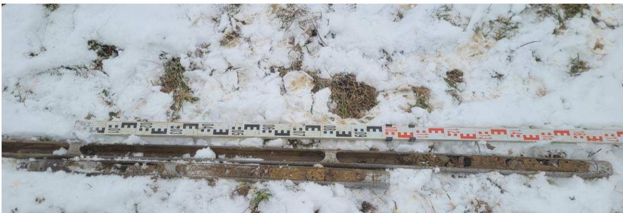
Foto 3: Typisches Bodenprofil für das Projektgebiet: Ein direkter Punktaufschluss wird hier mit einer Rammkernsondierung (Durchmesser 60 mm) realisiert. Durch den Rammvorgang wird das Bodenmaterial oft kompaktiert, daher kann die Zuordnung der Tiefe abweichen.
