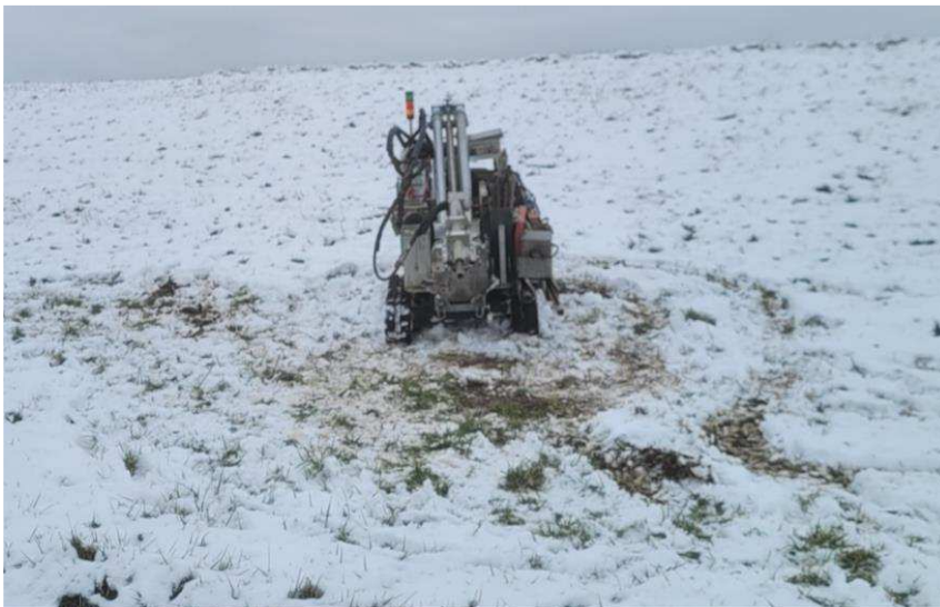
Foto 2: Die Erkundungsarbeiten wurden mit einer ferngesteuerten Sondierdraupe Typ "ARGOS" durchgeführt. Der hydraulische Hammer bringt 111 Joule auf die Sonden.
